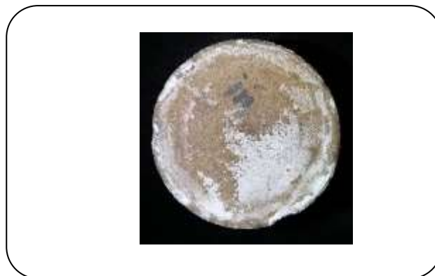
شکل ۶ - تصویر ورودی نمونه سنگ در پایان آزمایش.
